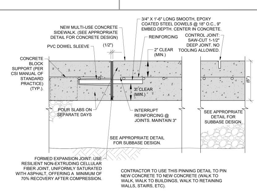
NEW CONCRETE CONSTRUCTION JOINT/CONTROL JOINT DETAIL
